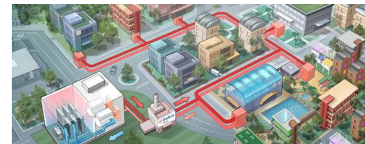
Récupération de chaleur sur Datacenter (Source : Dalkia)
