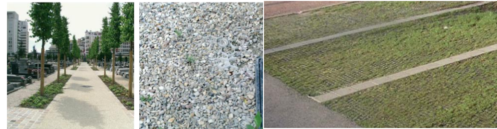
Exemple de revêtement poreux (Source : CG 92)
