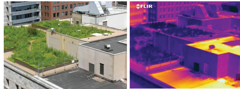
Mesure de la différence de température entre une toiture classique et une toiture végétalisée (Source : Report US EPA)
