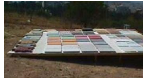
Exemple de mesures et comparaison des différences entre la température de surface du matériaux et l'air 1
